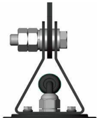
Рис. 1. Установка крепления на светильник.
